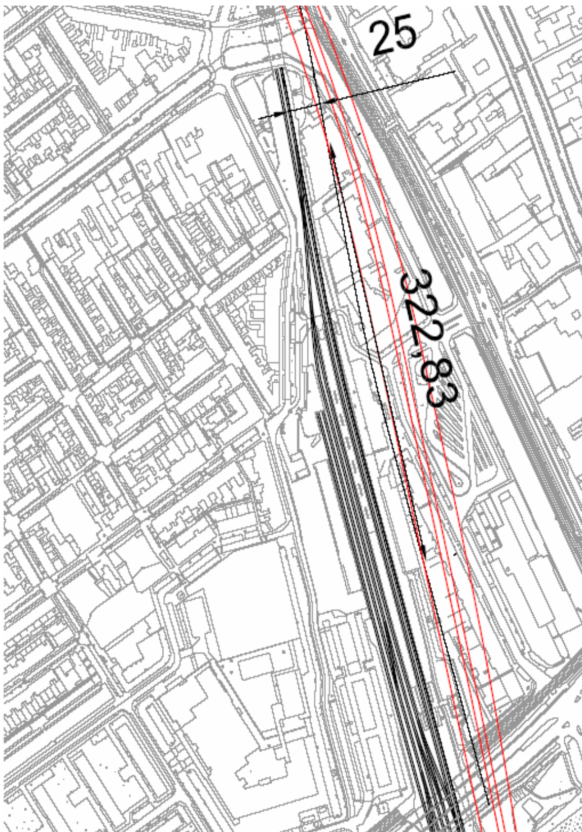
Figuur 3 Lengte waarover de verschuiving van het spoor meer dan 25 m bedraagt
