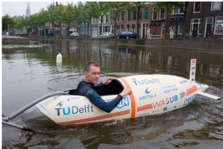
de 'Wasub' een door menskracht aangedreven onderzeeboot, ontwikkeld in Delft
