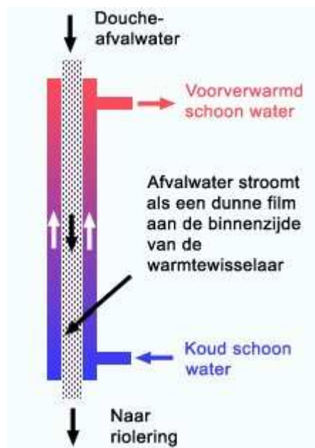
figuur 7.5 Principeschema werking warmteterugwinning douchewater
