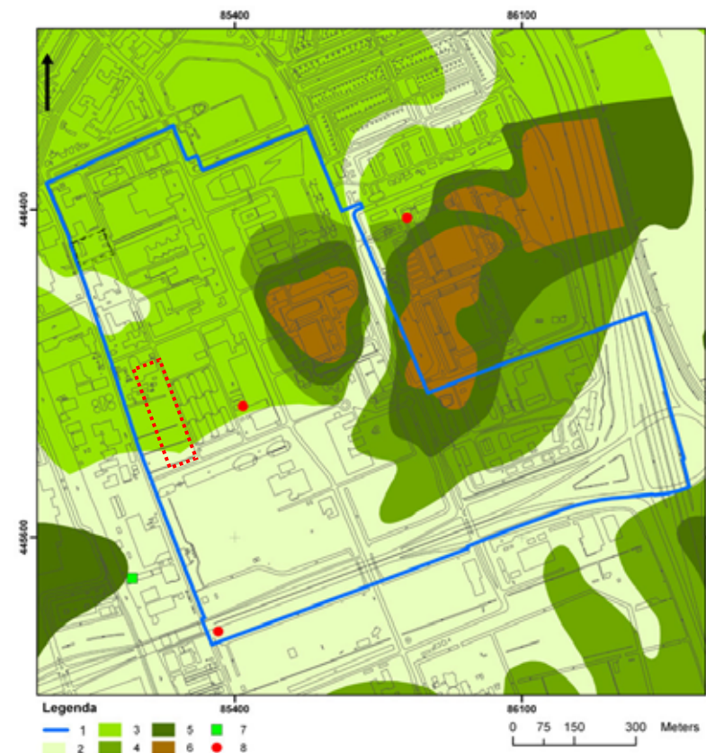
Figuur 13: Geologische kaart van de TU-Campus met de bekende archeologische vindplaatsen
